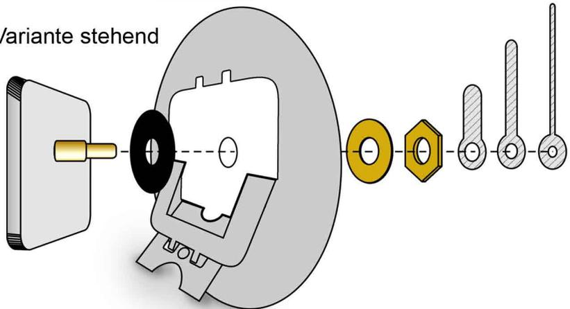
Montieren Sie die Uhrzeiger in der 12-Uhr-Stellung. So können Sie am leichtesten sicher stellen, dass die Zeiger gerade zueinander montiert sind und sich gegenseitig nicht berühren.
